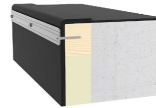
Montáž na betonový okraj
